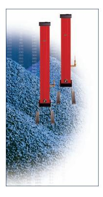
Le temps de contact, le diamètre interne de la colonne et la quantité de charbon sont étudiés pour obtenir une teneur résiduelle en hydrocarbures jusqu'à 0,003 mg/m³, et une durée de vie de la charge de l'ordre de 10000h de fonctionnement,à condition de respecter les préconisations d'utilisation.
