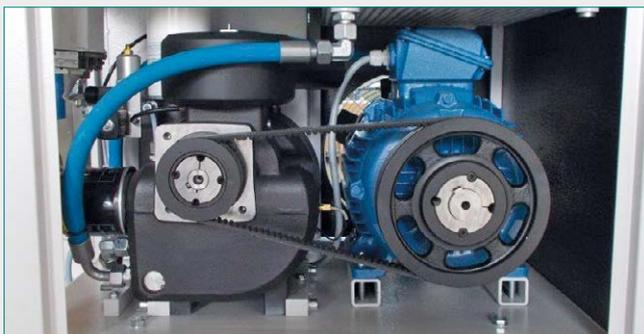
Bloc à vis comme module intégré : pas de réservoir d'huile séparé et pièces de maintenance facilement accessibles.
