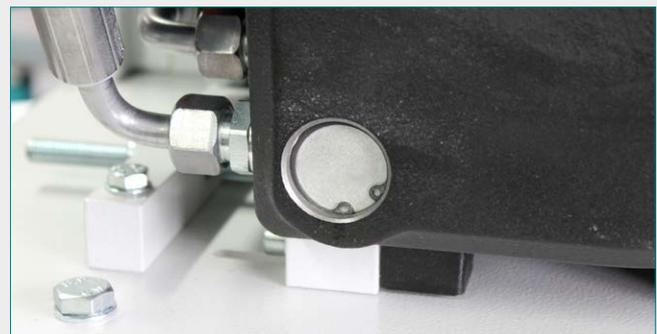
Le thermostat à huile intégré permet de se passer des conduites et des éléments de fixation.
