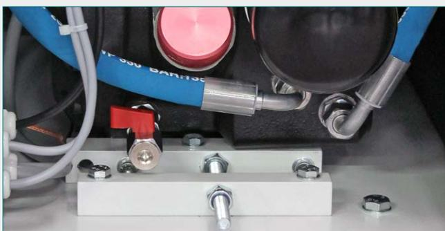
Tension de courroie simple : grâce au déplacement du bloc à vis, une vis de réglage permet de régler et de sécuriser la courroie.
